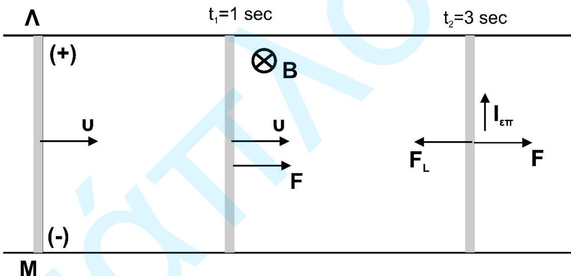
Στο χρονικό διάστημα  $t=0$  ως  $t_1=1\text{ s}$  η ράβδος δέχεται μηδενική συνισταμένη δύναμη. Άρα  $\Sigma F = 0 \Rightarrow a=0$ . Η ράβδος εκτελεί ευθύγραμμη ομαλή κίνηση με ταχύτητα  $v_{\max} = 1 \frac{m}{s}$ .
